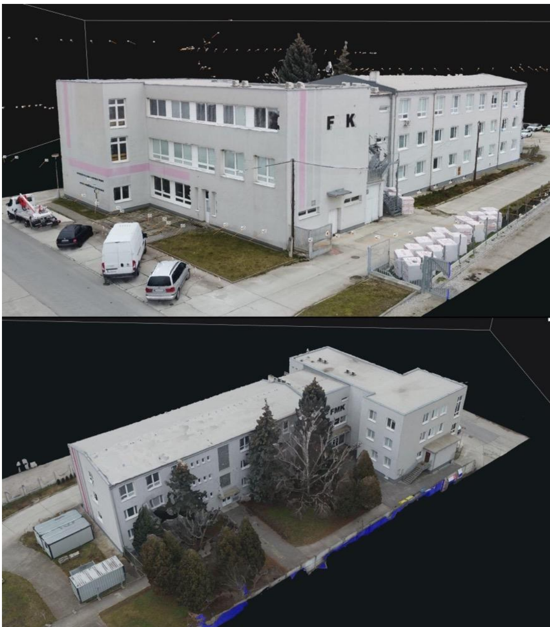
Obrázok 9: Finálny model vytvorený z 436 fotografií s využitím RealityCapture Zdroj: vlastné spracovanie.
