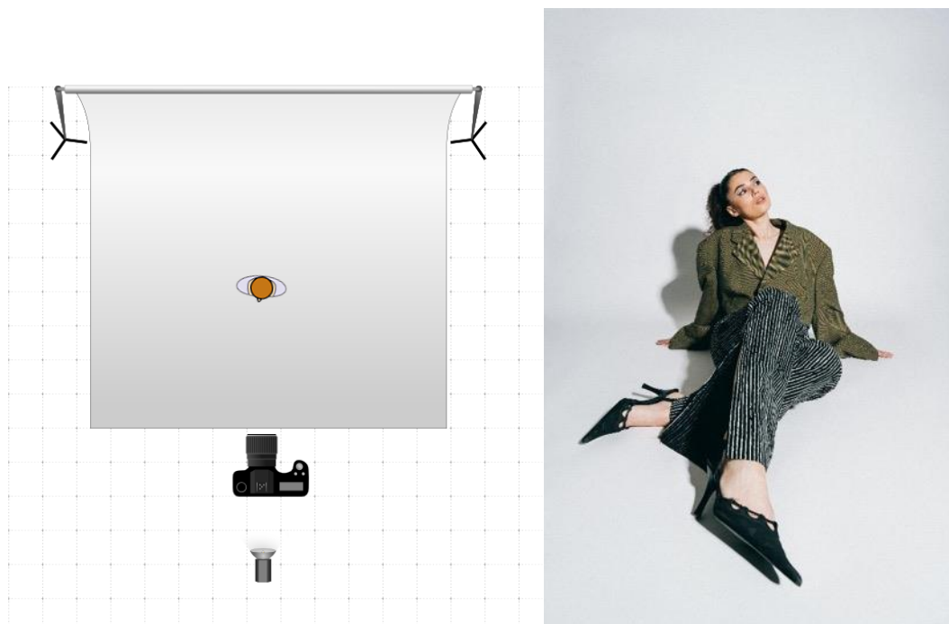
Obrázok 12: Schéma a ilustrácia direct flash svietenie (f9, 1/160s, ISO 100, Sony a7RIII a Sigma 24-70 2.8 objektív)
