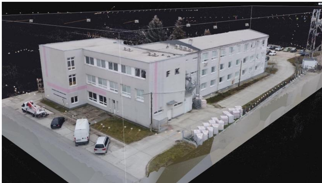
Obrázok 7: RealityCapture, 436 fotografií, zjednodušený a textúrovaný model Zdroj: vlastné spracovanie.
