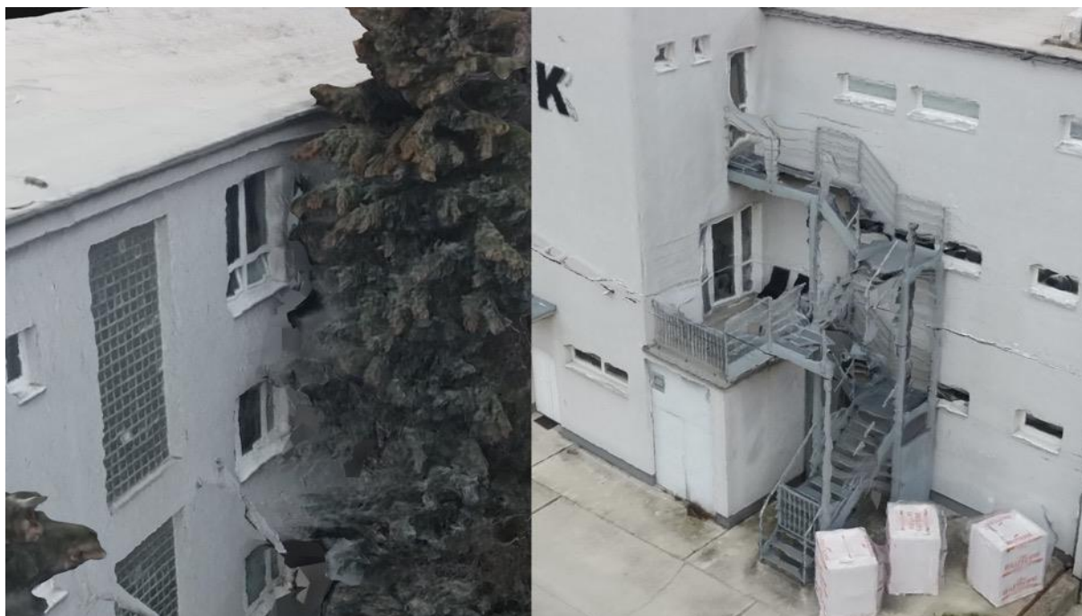
Obrázok 10: RealityCapture, 436 fotografií, výrazne nežiadúce alebo inak chybné časti modelu Zdroj: vlastné spracovanie.
