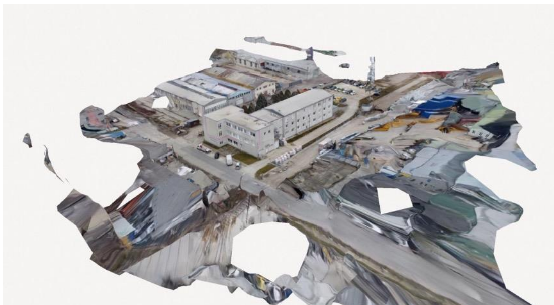
Obrázok 6: Oddialený 3D model vytvorený z 250 fotografií programom Polycam Zdroj: vlastné spracovanie.
