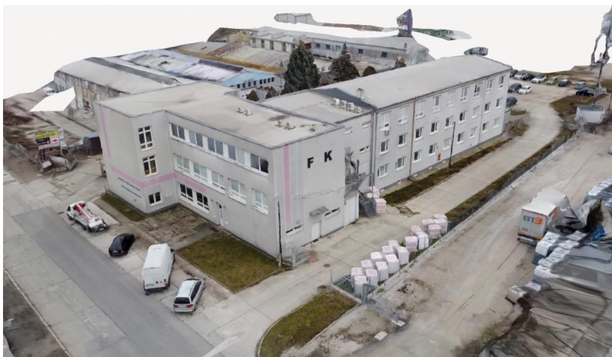
Obrázok 5: Približený 3D model vytvorený z 250 fotografií programom Polycam Zdroj: vlastné spracovanie.
