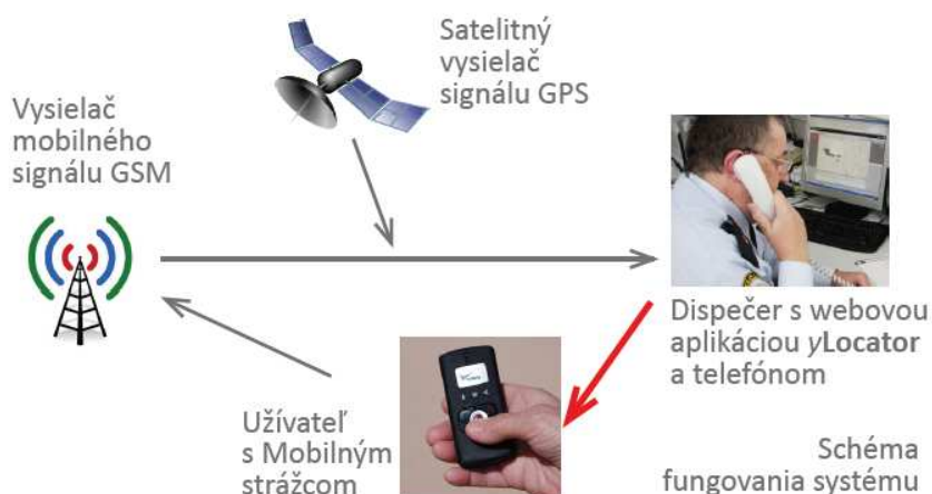
Obrázok 2 Systém monitorovania, signalizácie potreby pomoci a zabezpečenia poskytnutia krízovej pomoci Zdroj: WWW.YMSGROUP.COM
